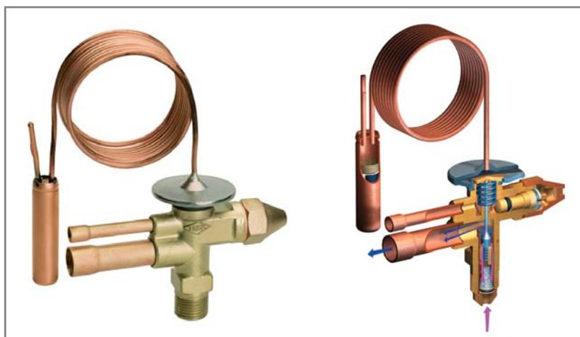
ТРВ как в горизонтальном, так и в вертикальном положении, при этом возможность миграции зарядки исключена. ТРВ сохранит работоспособность, даже когда температура термоголовки опустится ниже температуры термобаллона. Кроме того, адсорбентная зарядка в отличие от жидкостной и газовой характеризуется постоянством отношения перепада давлений к изменению температуры при различных температурах кипения хладагента, что упрощает настройку перегрева, а
